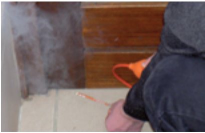
Abb.A3: Dereinfache Luftströmungstest
