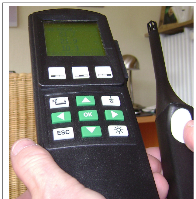
Abbildung 01: Luftfeuchtemessung mittels Thermohygrometer:
